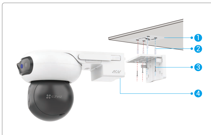
Obr. 1 Montáž na strop
